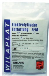
3040400103 Avfetting 50g, blandes i 1l destillert vann. Brukes ved 20-25° og 7-8V i ca1min.
