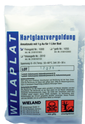
3100101903 Forgylling for elektrolyttisk forgylling. Pulver, blandes i 1l destillert vann. In- neholder 1g gull. Brukes ved 60-70° 6-8V i 20-30sek.
