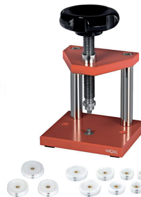
07.131 Horotech 07.131 bak- klokkespresse med 12 innsatser 110 x 95 x 210 mm 1stk flat 45 mm lyreform 1stk 17 mm 1 stk 22/25 mm 1 stk 26/29 mm 1 stk 30/33 mm 1 stk 34/37 mm 1 stk 38/41 mm
